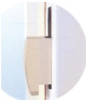
Os fechos basculantes em gancho são uma das características específicas das fechaduras de segurança Fichet. Com uma volta se chave, os fechos engatam na ranhura e graças aos movimentos em sentidos opostos, qualquer tentativa de destravamento é extremamente complicada. Na nova fechadura VERTIPONTOS, foram aumentadas as dimensões dos fechos para aumentar ainda mais a resistencia da fechadura.
